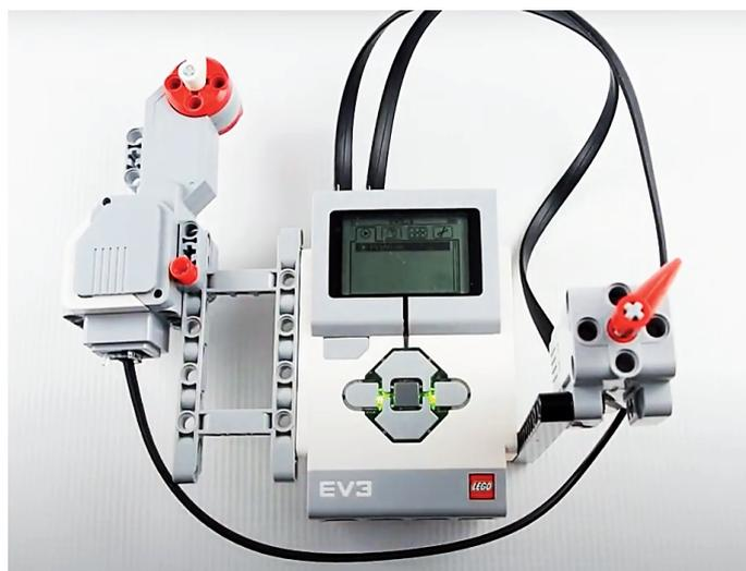
Рис. 2. Пример контроллера робототехнического набора Lego Mindstorms Ev3
